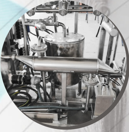
Proses koşullarında hızlı ısıtılabilen buhar eşanjörü Steam exchanger with rapid heating during processing
